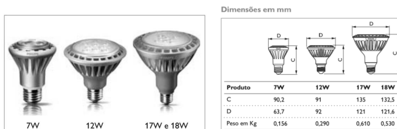
Figura 13 - Especificações de algumas lâmpadas LED Fonte: Portal da empresa PHILIPS 4
